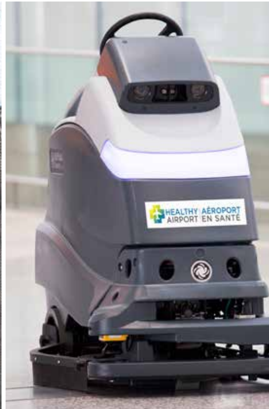
De gauche à droite : Les stations UV CleanSlate de nos aéroports assainissent les appareils électroniques; la technologie électronique portable à équation d'onde incite les membres de l'équipe à maintenir une distance physique et soutient le traçage des contacts; les nettoyeurs de plancher autonomes utilisent la technologie UV-C pour désinfecter.
